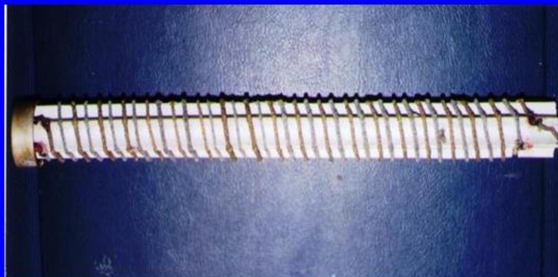
Figura 5.5.2.1 Características de la fulgurita de un fusible limitador de corriente
